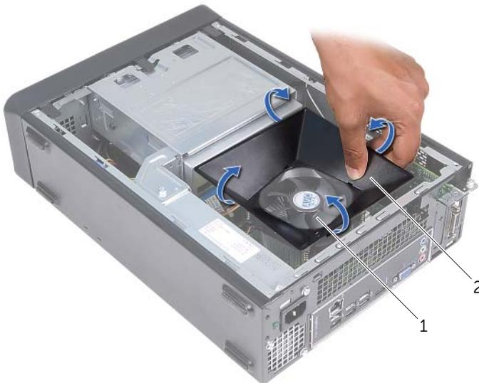
1 ventilator procesora i sklop hladila procesora
